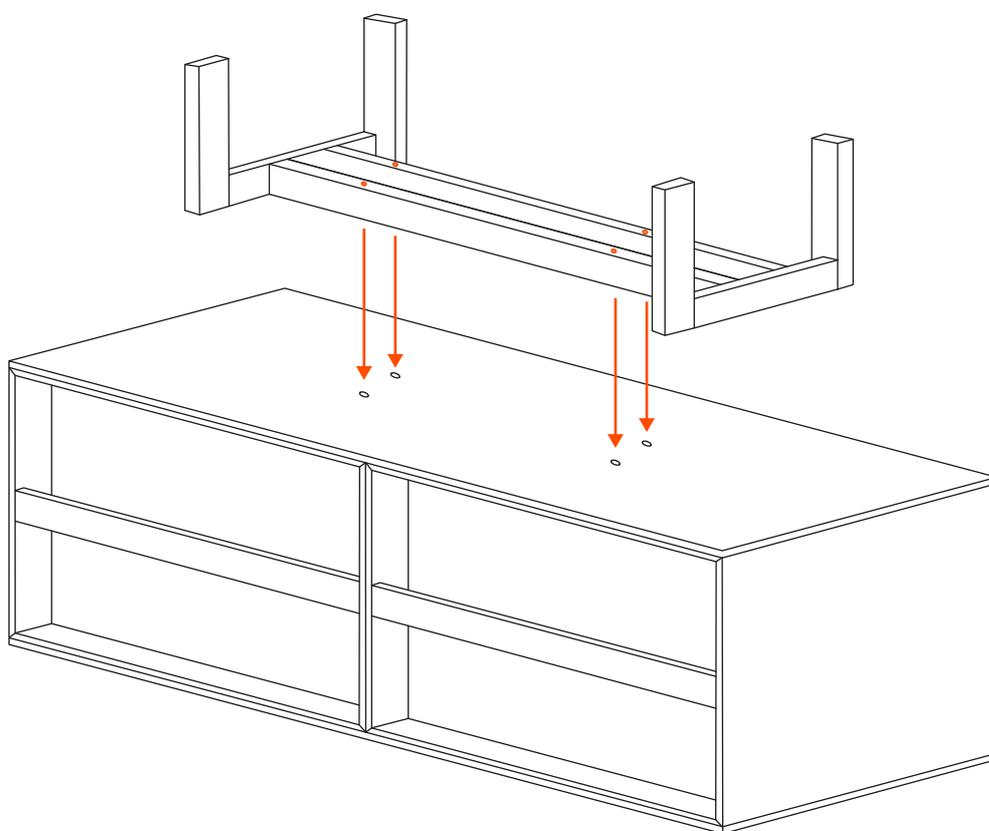
Posizionare la base sul corpo dell'armadio (sottosopra).
